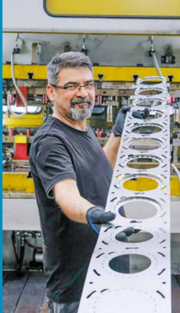
AUF EINEN BLICK: Diese Leiste zeigt die Abfolge der Fertigungsschritte, an deren Ende die Ringe für das Tankverschlussssystem stehen.
